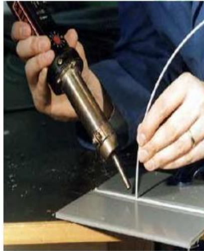
Şekil 14: sıcak gaz kaynağı
