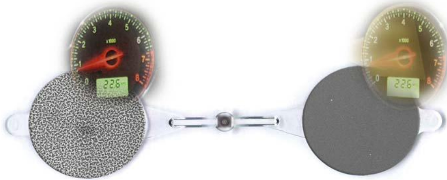
Şekil 8. DSKK yöntemi ile üretilen gösterge (yansıma yapmıyor) ve geleneksel kalıplama yöntemi ile üretilen gösterge (yansıma yapıyor) [10]
